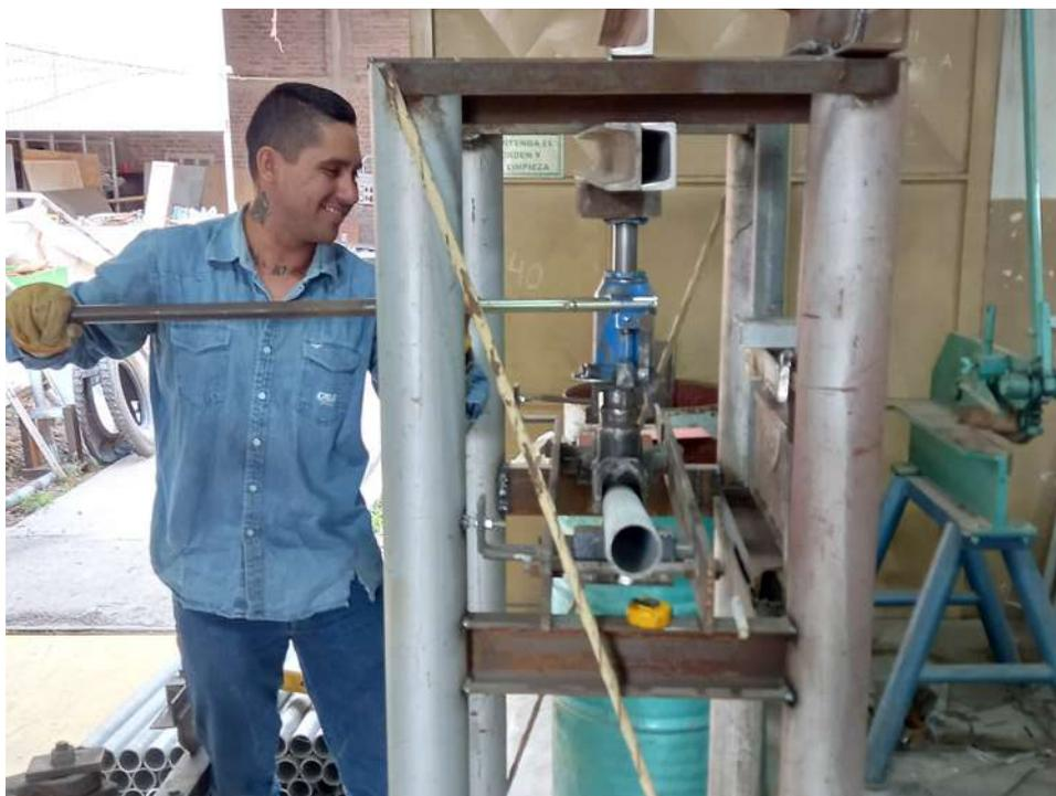
see CALF en el PIN, ahí se cortan los tubos que luego son trasladados esos tramos hasta el sector. El paso siguiente es el doblado, colocación de antioxido y pintado hasta llegar a la cantidad convenida, y luego es trasladada hasta el depósito en el barrio 14 de Octubre, para integrar el stok dispuesto para su retiro cuando sea necesario.
