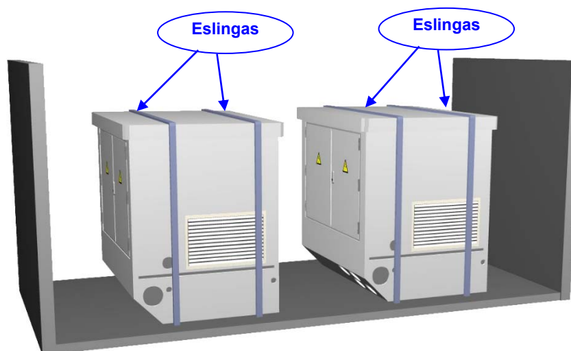
Figura 2.1: Detalle de eslingas en transporte marítimo
